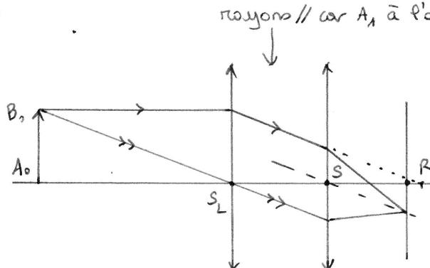
c) En accommodant au maximum  $V_{\max} = \frac{1}{S_R} + \frac{1}{d_m}$  avec  $d_m = 1m$
