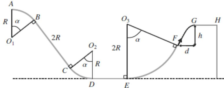
AB : partie circulaire de centre  $O_1$ , de rayon  $R = 40 \text{ cm}$  et d'angle  $\alpha = 30^\circ$ .
